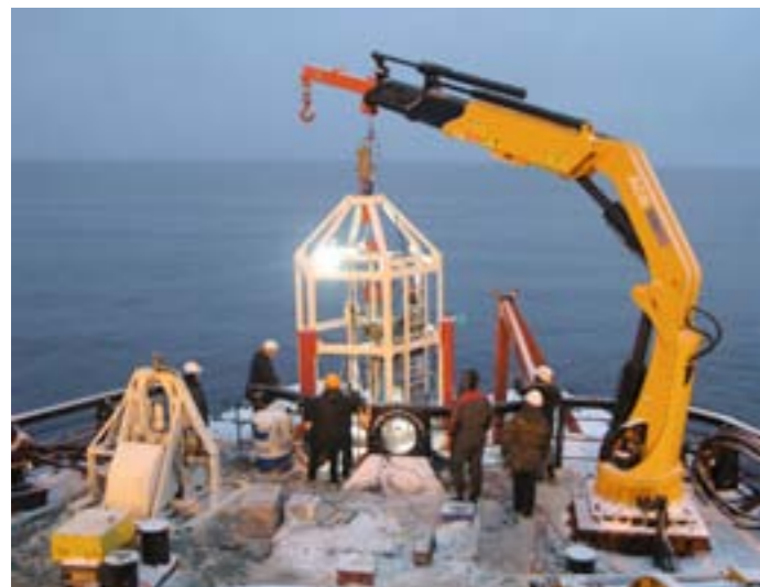
Проверка глубоководной буровой установки ГБУ-2 перед спуском
