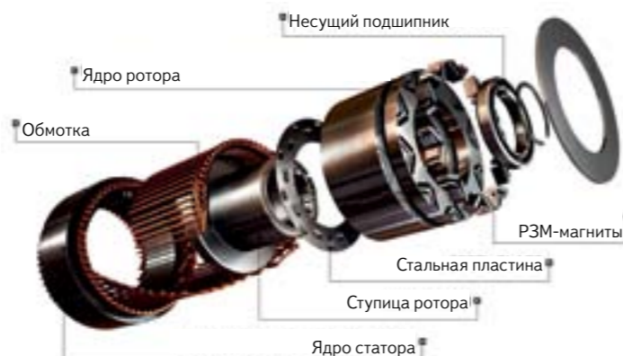
СХЕМА ТИПОВОГО ЭЛЕКТОРОДВИГАТЕЛЯ С РЗМ-МАГНИТАМИ
